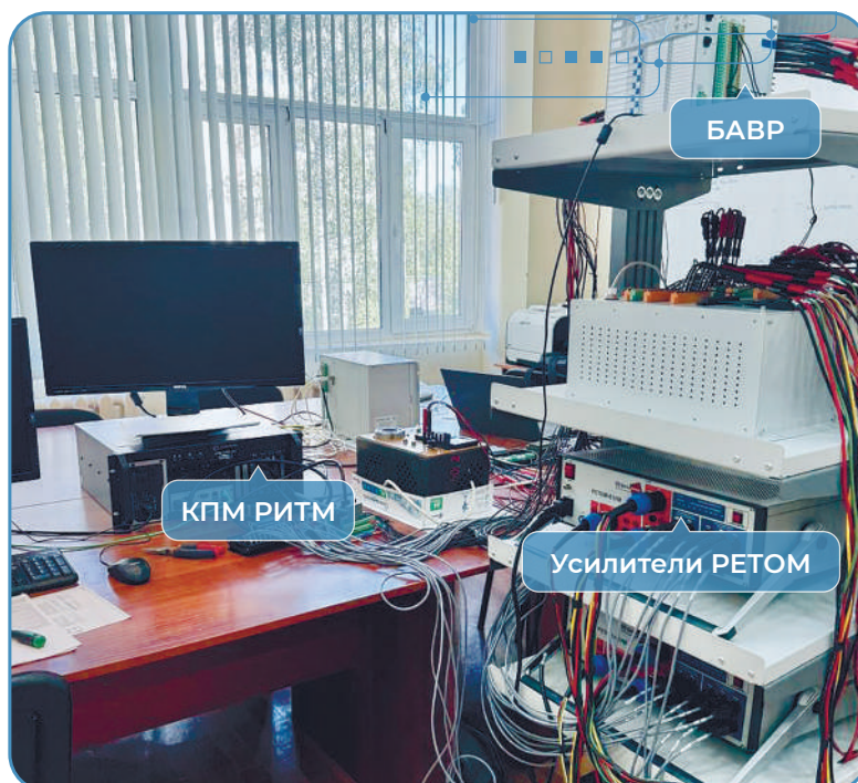
Фото с проведения испытаний БАВР в ЧувГУ
